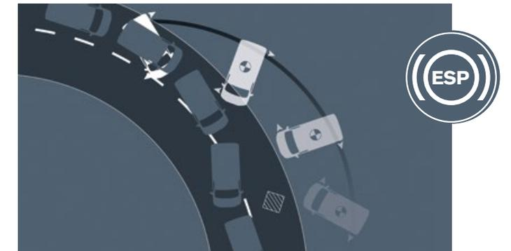
L'ESP gère le comportement dynamique du véhicule et contrôle vos actions sur le volant et les freins. S'il identifie un sur- ou sous-virage, il réduit votre vitesse en freinant chacune des roues pour aider à corriger la trajectoire.
