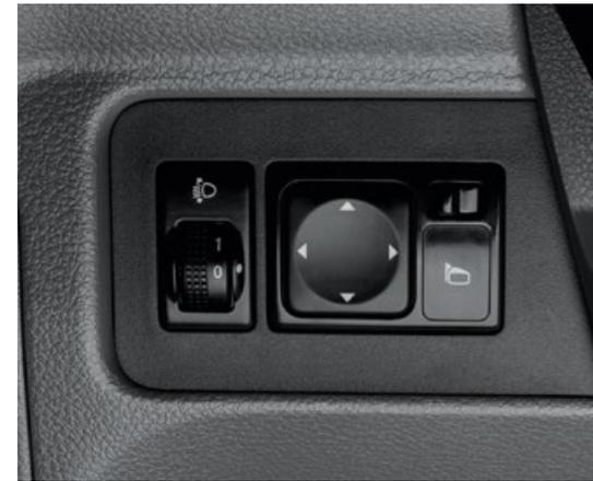
Commande électrique des rétroviseurs extérieurs et du réglage en hauteur des phares
