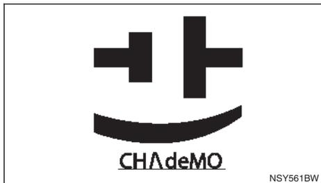
La charge rapide peut être effectuée sur des stations de charge publiques (jusqu'à 50kW de puissance). Les chargeurs rapides compatibles ont été développés en fonction du standard ChaDeMo et peuvent être identifiés par le symbole indiqué ci-dessus.
