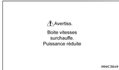
Cette boîte de vitesses hybride bénéficie d'un mode de protection contre les températures élevées du liquide de boîte de vitesses. Si la température du liquide de boîte de vitesses est trop élevée, (par exemple, lors de l'ascension de
